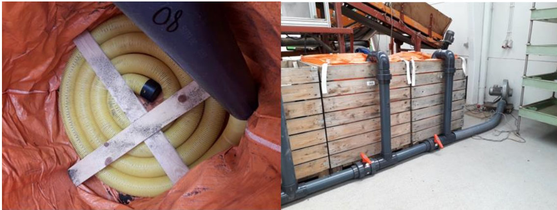
Figuur 2.1.2: Een zelfgebouwde drooginstallatie zorgt ervoor dat de bloemen en zaden snel gestabiliseerd worden op het bedrijf. De bloemen of zaden worden bovenop een opgerolde drainagebuis gestort die aangesloten is op een ventilator.
