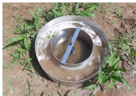
Figuur 4.1.3: Bepalen van de verzadigde infiltratiesnelheid aan de hand van een dubbele ringinfiltrometer.
