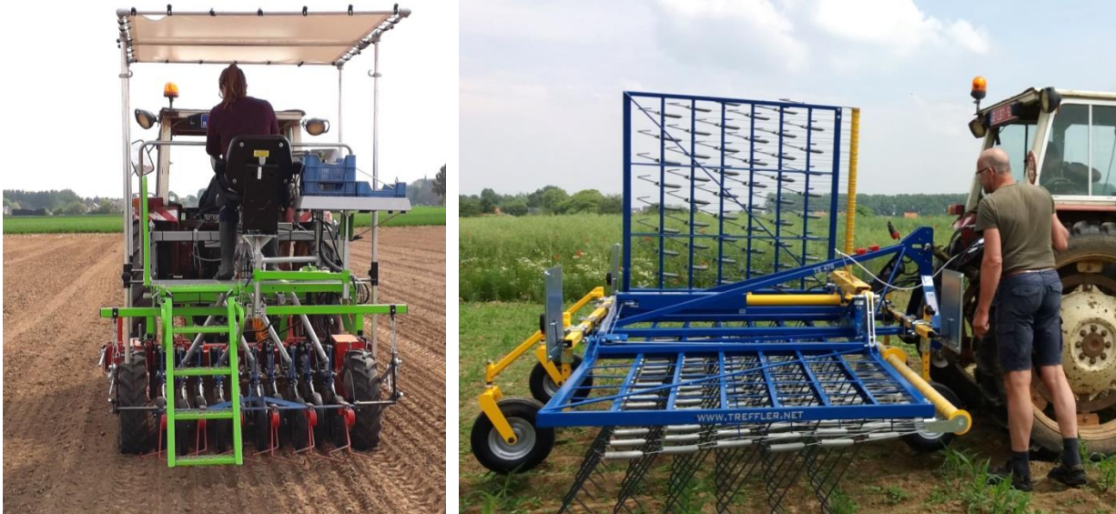
Figuur 2.2.4: De proefveldzaaimachine (links) maakt het mogelijk om zeer nauwkeurig op kleine oppervlaktes te zaaien, de wiedeg (rechts) wordt gebruikt voor mechanische onkruidbeheersing.
